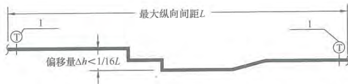
图 22 刚性连接水平管道纵向偏移示意
